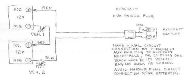
TWO 12-VOLT AUTOMOBILES ] FOR STARTING OR AUTOMOBILE BATTERIES ] FOR PROLONGED GROUND OPERATION OF AVIONICS
